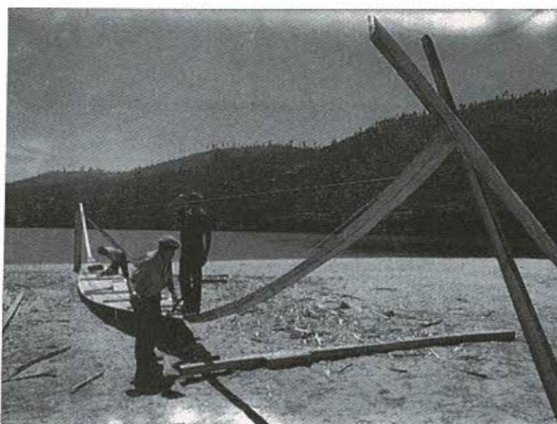
3.5. — Passava-se então à fase de *vestir o barco*, ou *urdir*, isto é, montar a parte exterior do casco. Esse trabalho era feito fiada a fiada, a começar do fundo para cima. A distância de cada fiada (a uma e outra borda) em relação a uma linha passada aos extremos das *oucas*, era verificada com a *régua de medidas* nos pontos correspondentes aos eixos transversais do *sagro*.
