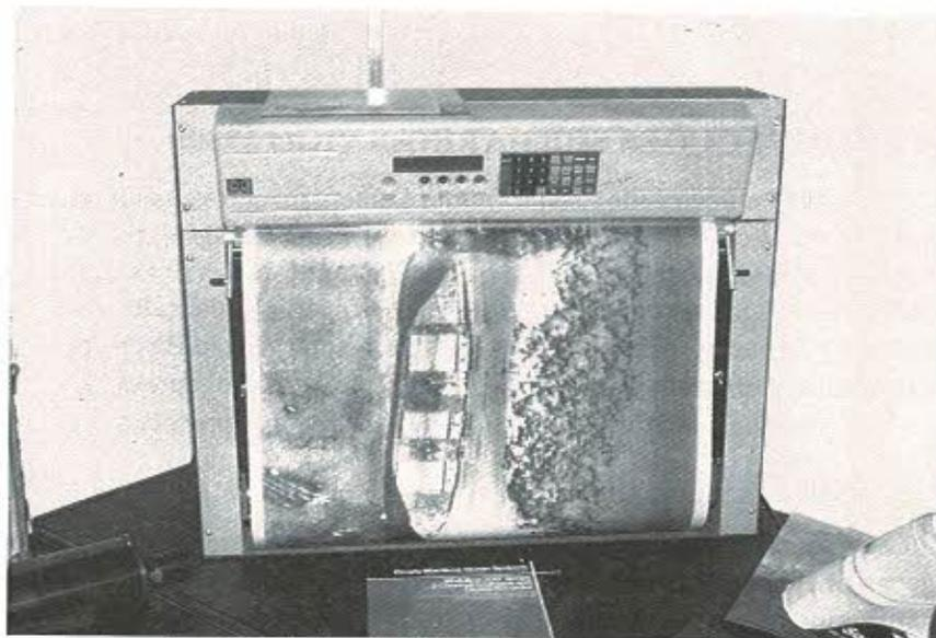
Registo de um navio de carga efectuado com um Side-Scan Sonar.
